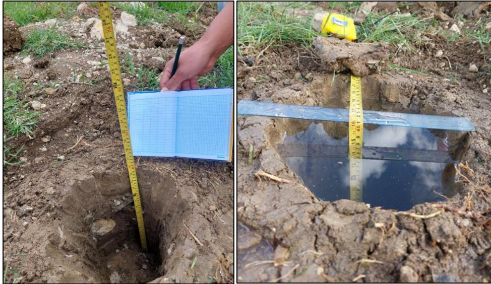
Figura 6. Ensayo de permeabilidad por el método de Porchet
