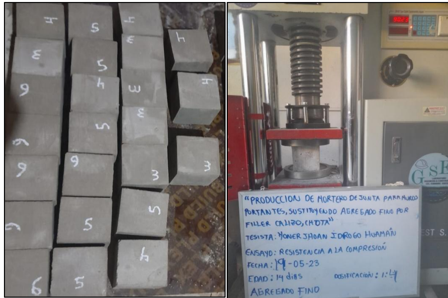
Figura 3. Prueba de resistencia a compresión en cubos de mortero
