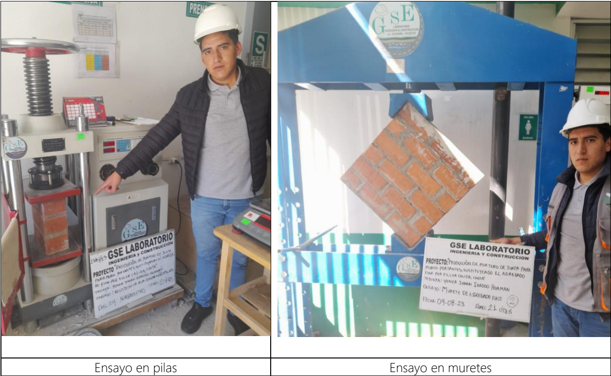
Figura 5. Ensayo en pilas y muretes de albañilería asentados con mortero cemento: arena o cemento: filler calizo según dosificación adecuada.
