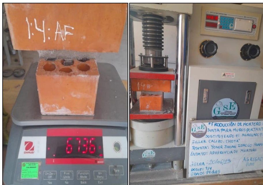
Figura 4. Espécimen de ladrillos cruzados sometido a ensayo de adherencia.
